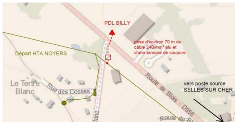
Figure 6 : Hypothèse de modalités de raccordement au poste source (Source : ENEDIS)
